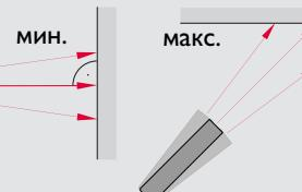
Эта функция используется для измерения диагоналей (максимальные значения) или горизонтальных расстояний до вертикальной поверхности (минимальное значение).
