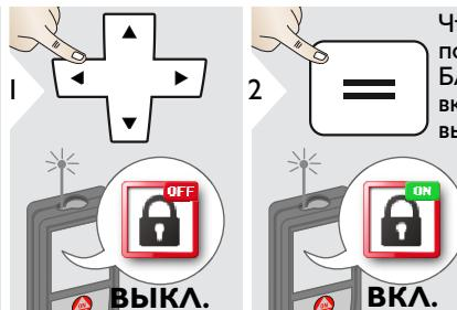
Чтобы деактивировать, повторите процедуру. Блокировка клавиатуры включена, когда прибор выключен.
