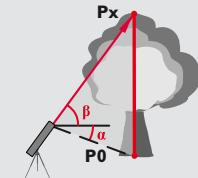
Направьте лазер на верхние точки и отслеживание угла/высоты начнется автоматически.
