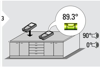
**i** Отклонение отображается постоянно. Прибор подает сигнал при углах 0° и 90°. Идеально подходит для регулировки горизонтали или вертикали.
