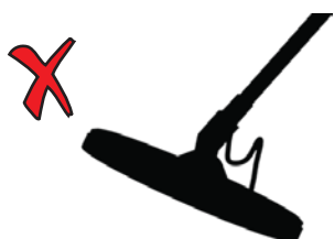
Неверный угол поисковой катушки к земле
