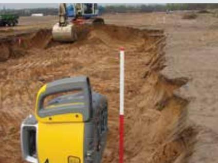
Автоматический самонивелирующийся лазер Spectra Precision® GL412N для одинарного уклона и GL422N для двойного уклона являются самыми прочными и экономичными лазерами, выполняющими три работы – нивелирование, профилирование и вертикальная разбивка. Даже в тяжелых условиях стройплощадок лазеры GL412N/GL422N постоянно обеспечивают надежные и точные результаты, позволяя вам работать быстрее и эффективнее.
