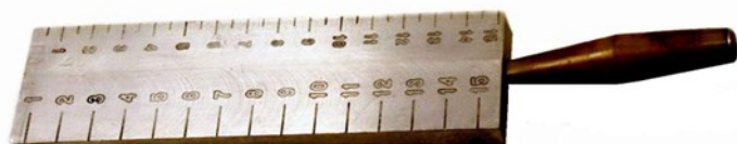
Рисунок 5 – Общий вид клинового промерника
