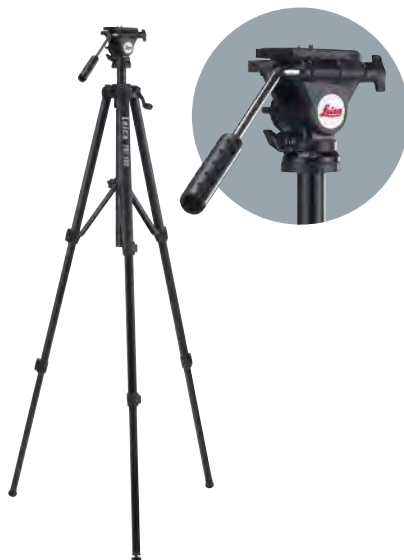
Штатив Leica TRI 100 Высококачественный штатив с пузырьковым уровнем и легкой возможностью точной настройки. Регулируемая высота от 0,70 м до 1,74 м. Арт. № 757 938
