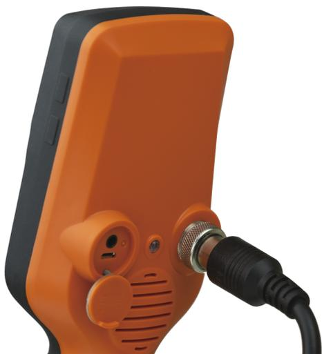
Откройте пыле- и влагозащитные заглушки разъемов. Закрывайте их обратно, чтобы избежать повреждения из-за жидкости или грязи.
