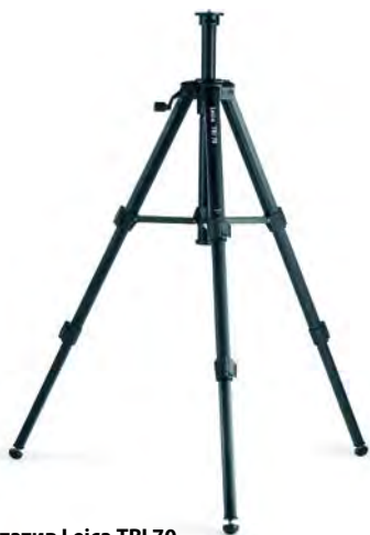
Штатив Leica TRI 70 Небольшой портативный штатив предназначен для повседневного использования. Он отличается возможностью точной настройки и наличием пузырькового уровня. Регулируемая высота от 0,40 м до 1,15 м. Идеально подходит для использования с адаптером Leica TA360 или FTA360. Арт. № 794 963
