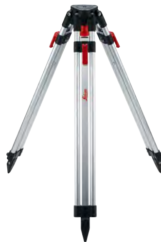
Штатив Leica TRI 200 Легкий и очень устойчивый алюминиевый строительный штатив с крепежным винтом 1/4", уровнем и клеммой стяжкой для простоты установки. Величина растяжения от 0,75 до 1,15 м. Идеально в сочетании с Leica FTA360 или FTA360-S. Арт. № 828 426
