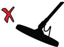
Неверный угол поисковой катушки к земле
