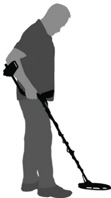
Высота штанги отрегулирована неверно
