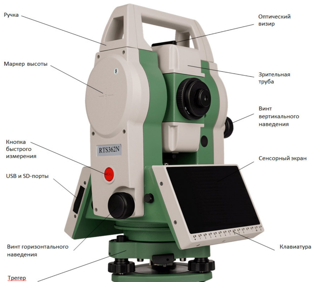
Рисунок 3 - Основные элементы тахеометра RTS362N и RTS010N
