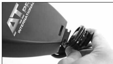
ВСТАВИТЬ ДЕРЖАТЕЛЬ ЭЛЕМЕНТОВ ПИТАНИЯ В УКАЗАННОЙ ПОЛЯРНОСТИ
