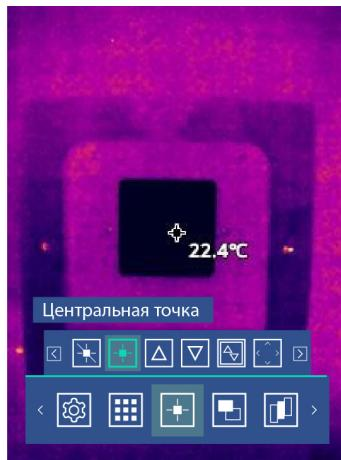
**Примечание:** для изменения размеров области измерения войдите в настройку области. Нажмите кнопку для того, чтобы изменить размер области измерения.
