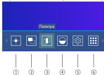
1. Измерение: настройка отображения измеряемых точек на экране тепловизора. Температура в центральной точке, самая высокая температура, самая низкая температура, температура в области.
