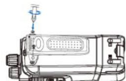
Закрепите клипсу на корпусе аккумулятора при помощи двух винтов, входящих в комплект поставки.
