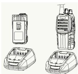
Подключите АС адаптер в сеть 220 Вольт и к зарядному устройству. Вставьте батарею или трансивер в зарядное устройство. Убедитесь, что клеммы батареи имеют надежный контакт с клеммами зарядного устройства. Пока индикатор на зарядном устройстве светится красным цветом, идет процесс заряда. Когда индикатор загорится зеленым цветом, процесс заряда завершен. Извлеките аккумулятор или трансивер из зарядного устройства.
